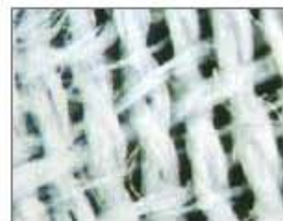
穴あきに至る前の畝部分が摩耗している生地
