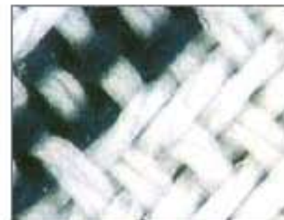
正常な状態の斜文織構造の生地
